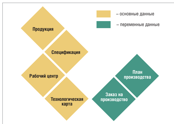
Рис. 7. Объекты синхронизации ERP и MES-систем
