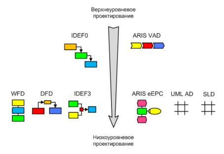
Рис.5. Методы проектирования процессов
